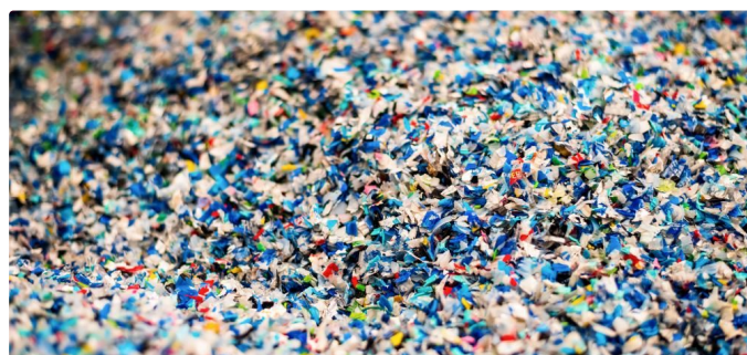
Zerkleinerter Kunststoff als Pyrolyse-Einsatzstoff. Quelle: abundiaimpact.com
